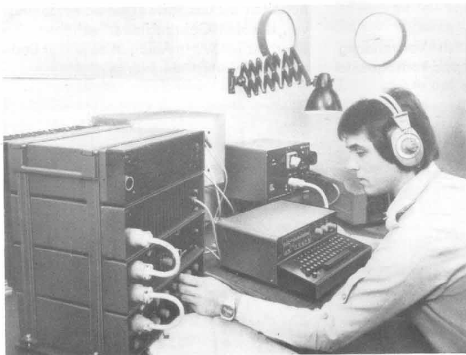
1 Automatischer Morsegeber MG 80 mit Stromversorgung SV 80 in Verbindung mit dem Sende-Empfangsgerät SEG 100 und dem Empfangsfernschreiber F 1200 im Einsatz
